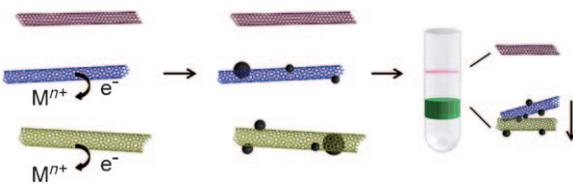
**Perfekt sortiert!** Durch Dichtegradienten-ultrazentrifugation gelingt die Abtrennung von einwandigen Kohlenstoffnanoröhren (SWNTs) gleicher Chiralität. Ein „Nanometallgewicht“ ( $\text{AuCl}_4^-$ -Ionen) adsorbiert an spezifische SWNTs und ermöglicht die
